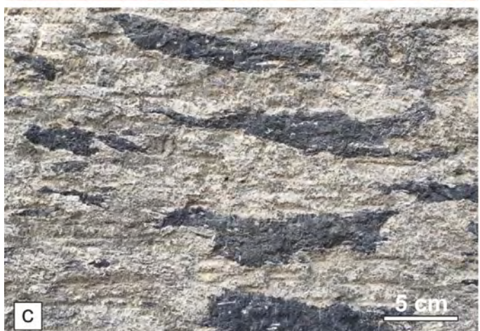
Figura 20. - (a) Tufo Giallo Napoletano; (b) microfotografia al microscopio elettronico di cristalli di phillipsite (zeolite); (c) Piperno con le classiche "fiamme" di scorie appiattite; (d) il castello del Maschio Angioino di Napoli.
