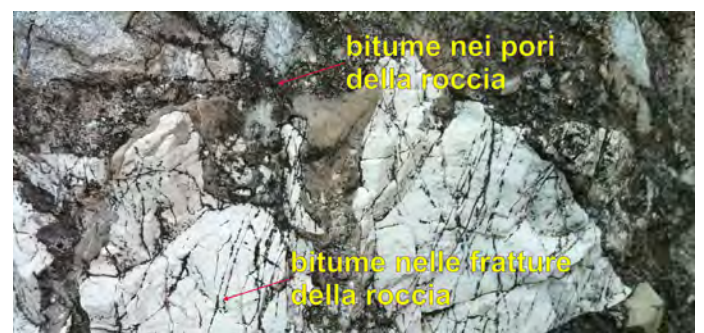
Figura 16. - Esempi di rocce madri nel nostro territorio: bitume nei pori e nelle fratture di una roccia carbonatica (Positano, SA).
